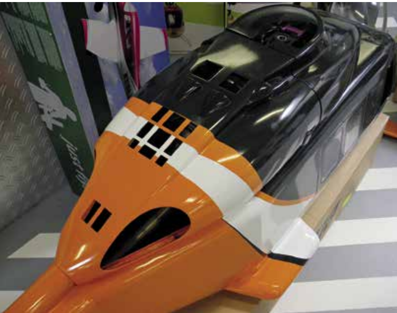
Die Mehrschichtlackierung mit dem leicht „abgestochenen“ Klarlack
