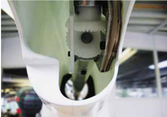
Das Winkelgetriebe ist seitlich an einer Sperrholzplatte befestigt
