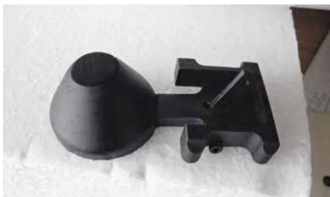
Der einbaufertige, ausfahrbare Suchscheinwerfer mattschwarz lackiert
