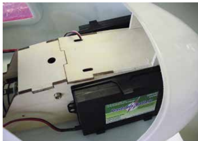
Alles Gewicht nach vorne – die Akkus von PowerBox für RC
