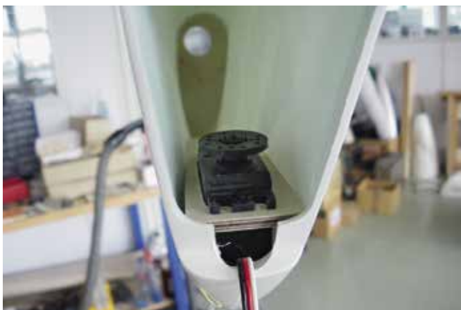
Das Heckservo findet im Heckausleger Platz, zu sehen die Öffnung für den Heckrotor
