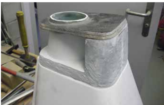
Zusätzlicher Spant aus Carbon/Balsaholz zur stabilen Verklebung des Hecks!
