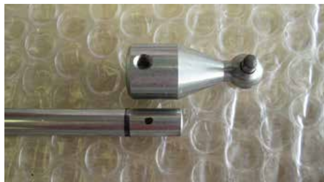
Die Kardan Kupplungen werden auf die noch anzufasende Welle geklebt und geschraubt
