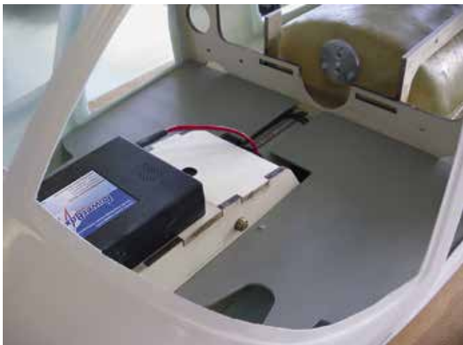
Der Cockpitboden wird eingepasst und provisorisch verschraubt
