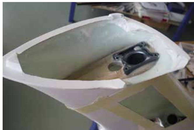
Der eingepasste Spant mit dem Adapter, seitlich die Serviceöffnung
