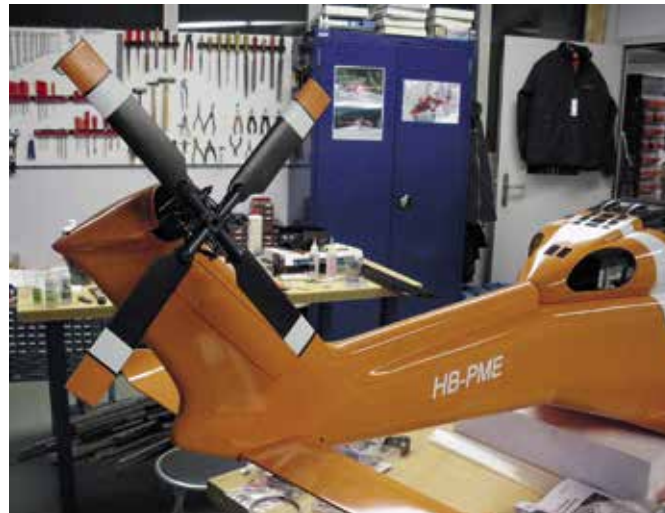
Die Endmontage beginnt, Heckrotor und Abdeckungen sind drin!
