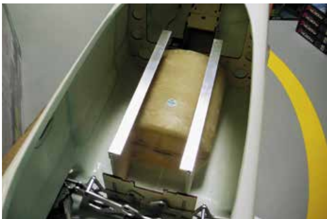
Die Alu-Profile nehmen später die Grundplatte der Turbinenmechanik auf
