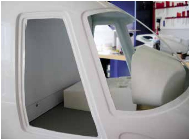
Die Cockpit bekommt seinen Platz vor der Rückwand mit Riffelblech
