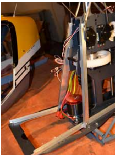
La découpe du châssis sera renforcée par des cornières alu qui rigidifient celui-ci latéralement et sur le devant qui doit recevoir la cabine.
