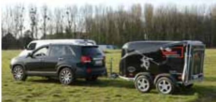
Pour transporter des machines de cette taille, il convient d'avoir une remorque assez vaste. Celle-ci est équipée d'un plancher coulissant (électrique), qui permet un accès total aux deux machines contenues.
