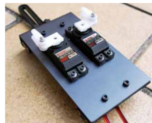
Am vorderen und hinteren Mechanikteil werden jeweils diese beiden Servo-Aluspanten eingebaut. An den Servohebeln sind bereits kugelgelagerten Anlenkköpfe verschraubt (Abstand 12,5 Millimeter)
