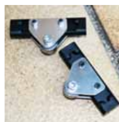
Die beiden im Text beschriebenen Andrucklager für das große Tellerrad
