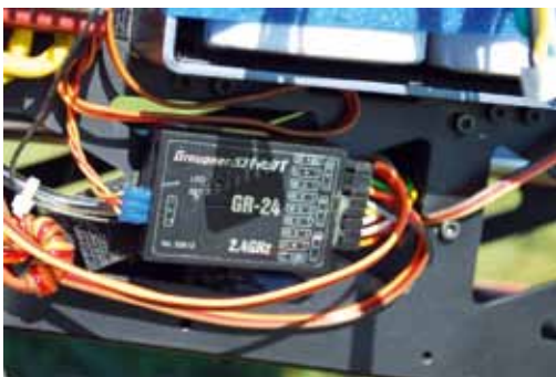
Der Graupner-Empfänger GR-24 sitzt unter dem Akkukasten. Er ist mit Klettband befestigt und kann somit leicht zu Einstellzwecken (Update) erreicht werden
