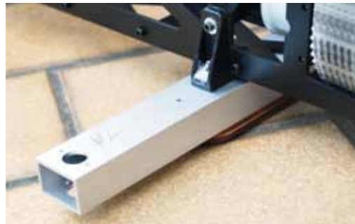
An der Mechanik verschraubte Kunststoff-Fahrwerksträger mit Bodenprofil
