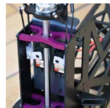
Anlenkung der Taumelscheibe mit den beiden Servos und vier Gestängen. Diese gehen V-förmig auseinander und bilden eine stabile 90-Grad-Anlenkung. Dadurch, dass kugelgelagerte Anlenkköpfe an den Servos verwendet werden und keine Kugelköpfe, sind die Gestänge nochmals richtungsstabiler
