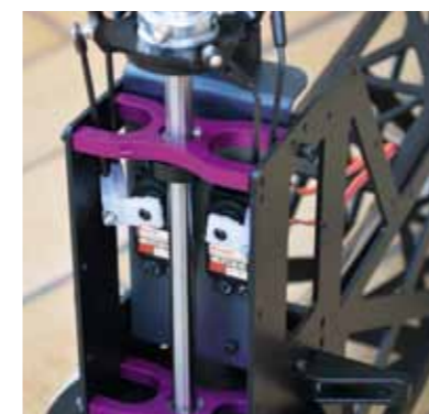
Anlenkung der Taumelscheibe mit den beiden Servos und vier Gestängen. Diese gehen V-förmig auseinander und bilden eine stabile 90-Grad-Anlenkung. Dadurch, dass kugelgelagerte Anlenkköpfe an den Servos verwendet werden und keine Kugelköpfe, sind die Gestänge nochmals richtungsstabiler
