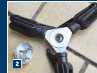
Das Zentralstück hat ein eingebautes Schwenklager, sodass der Rotorkopf – ähnlich einer Taumelscheibe – frei auf der Hauptrotorwelle pendeln kann
