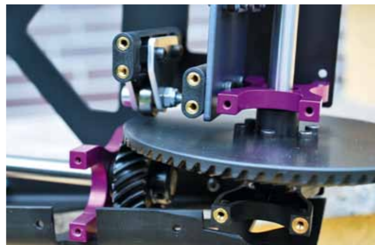
Die pallloidverzahnten Zahnradpaarung für die beiden Hauptrotorantriebe stammen aus dem Turbinenbereich. Deutlich zu erkennen ist auch das kleine Stützkugellager auf dem großen Tellerrad
