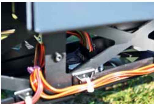
Das „Gehirn“ unseres Tandems ist das Flybarless-System BavarianDemon 3SX. Dieses sitzt innerhalb des Mechanikkastens auf dem Boden
