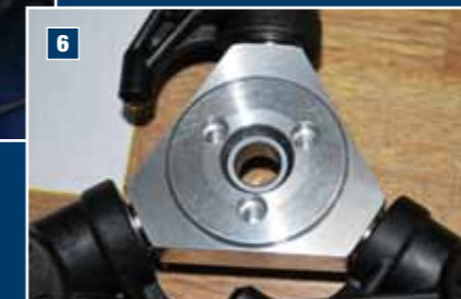
Das Zentralstück hat drei Vertiefungen für die Aufnahmestifte
