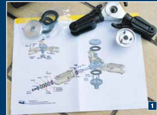
Explosionszeichnung des Dreiblatt-Hauptrotors. Die Blatthalter sind bereits montiert und die Drucklager gefettet
