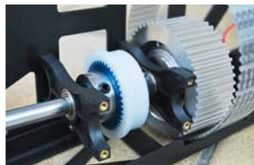
Hier die solide gefertigte 10-mm-Antriebswelle mit dem Kegelrad für den vorderen Rotor, die so montiert 814 Gramm wiegt. Das große weiße Innenzahnrad im Vordergrund ist die Kupplung zur Verbindungswelle, was in montiertem Zustand ...
