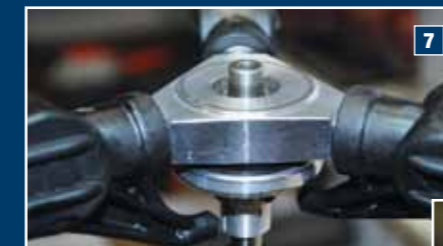
Das Zentralstück ist mit seinem Schwenklager auf die 10-mm-Hauptrotorwelle aufgesetzt
