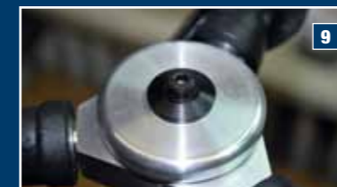
Im Oberteil sitzt der zweite Dämpfungsgummi. Der Deckel liegt zunächst nur auf dem Zentralstück auf und wird von oben mit der M4-Schraube und der schwarzen U-Scheibe mit der Rotorwelle verschraubt
