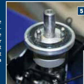
Der erste Dämpfungsgummi und die Stifte müssen vor der Montage mit reichlich Fett versehen werden
