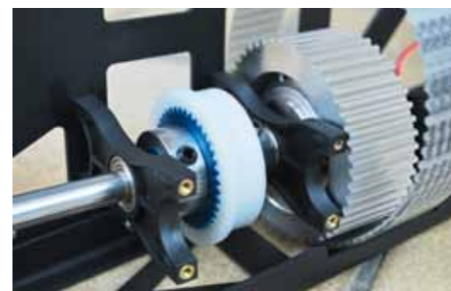
... so aussieht. Die beiden M5-Schrauben an der Kupplungsverbindung werden gelöst und der vordere und hintere Rotor so lange verdreht, bis sie parallel stehen. Das gewährleistet ein Ineinanderkämmen der Rotoren
