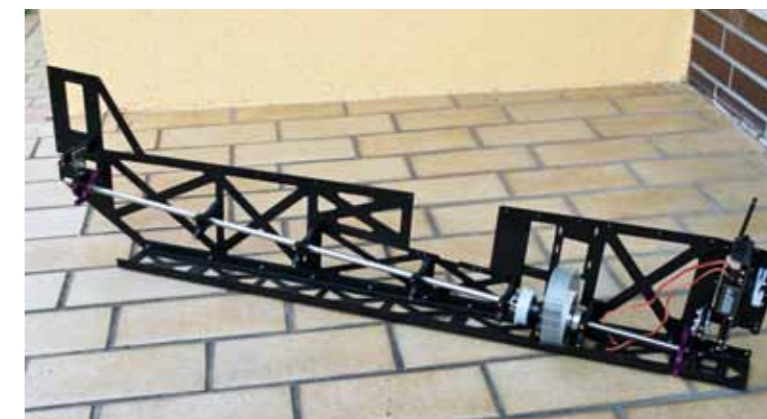
So wird das Verbindungsrohr aus 10-mm-Edelstahl mit seinen Lagerböcken im Seitenteil eingebaut
