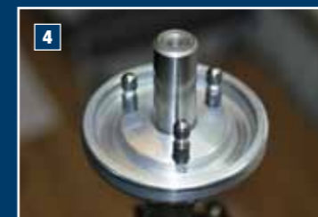
Die drei Aufnahmestifte, die das Drehmoment auf das Zentralstück übertragen
