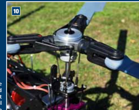
Der fertig mit Anlenkungen versehene Dreiblatt. Er besitzt eine definierte und super weiche Dämpfung. Wird ein Blatt angehoben, ändern sich die Anstellwinkel der beiden anderen Blattarme
