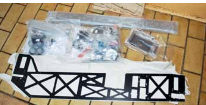
Im Vordergrund eines der beiden schwarz eloxierten Mechanik-Seitenteile, die aus 2,5 mm starkem Alu bestehen
