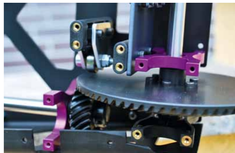
Die pallloidverzahnten Zahnradpaarung für die beiden Hauptrotorantriebe stammen aus dem Turbinenbereich. Deutlich zu erkennen ist auch das kleine Stützkugellager auf dem großen Tellerrad
