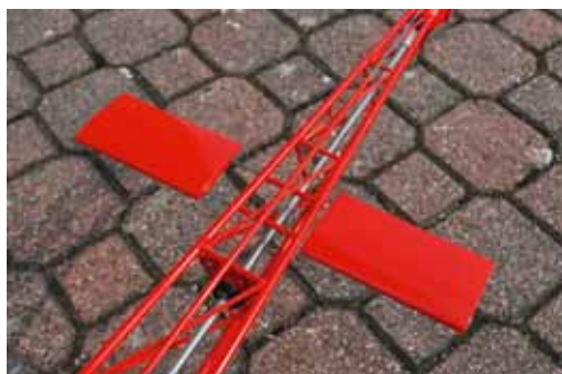
Lagerung der GFK-Höhenleitwerke. Am Rumpf sind entsprechende Edelstahlröhrchen verlötet, in denen die beiden Stahldrähte sitzen, auf die die Höhenleitwerkshälften gesteckt werden
