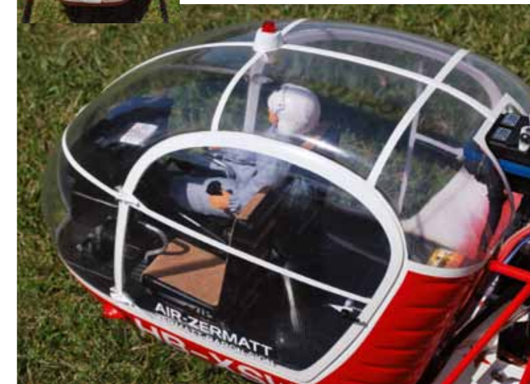
Die klare Kabinenhaube wurde mit Zweikomponentenlack gespritzt. Hierzu musste sie innen und außen abgeklebt werden. An der Frontseite besitzt die Alouette Wartungsklappen. Diese wurde beim Modell mittels ABS-Streifen aufgesetzt
