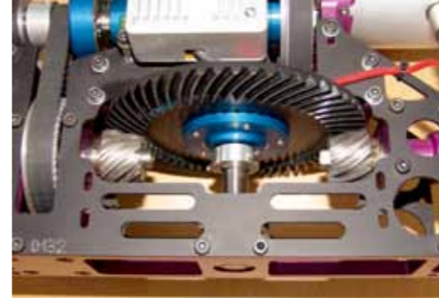
Das robuste Hauptgetriebe der PHT2. Im Bedarfsfall lässt sich die Drehrichtung des Hauptrotors durch horizontales Drehen des Hauptzahnrad um 180 Grad reversieren
