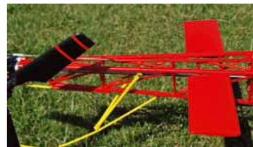
Auch der Hecksporn wurde pulverbeschichtet, hier jedoch gemäß bemanntes Vorbild in Gelb
