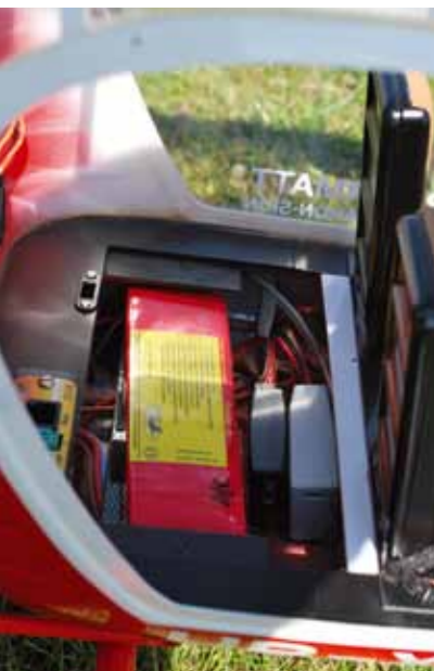
Der hintere Teil des Cockpitbodens wird nur mit Magneten gehalten, um den Zugang zum Turbinen-LiPo und den Steckanschluss des USB-Kabels des V-Stabi zu ermöglichen
