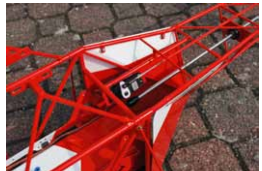
Das Heckrotorservo sitzt im Gitter-Heckausleger und lenkt über einen Stahldraht den Heckrotor-Umlenkhebel an. Unmittelbar vor dem Servohebel ist der Kupplungsanschluss der Heckrotor-Antriebswelle zu erkennen
