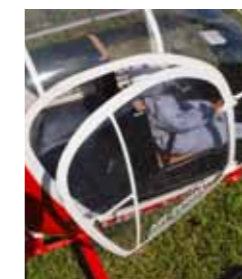
Die mit jeweils zwei Scharnieren befestigten Türen werden mit Türklinke und Magnet zugehalten
