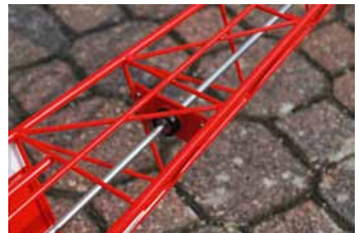
Konstruktion der Heckwellenlagerung in Verbindung mit der Edelstahlwelle. Die Schellen, mit denen die Platte am Heckausleger verschraubt wird, wurden vor der Pulverbeschichtung mit dem Rumpf hartverlötet, die Kunststoffteile lackiert
