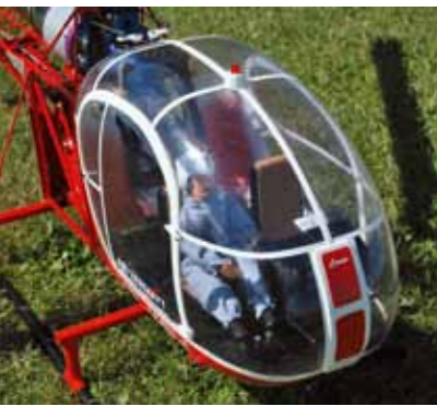
Das Cockpit ist ein Eigenbau aus Sperrholz und ABS. Es lässt sich zu Wartungszwecken komplett herausnehmen
