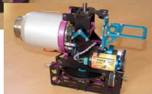
Die äußerst kompakt bauende JetCat-Mechanik PHT2, bei der die Turbine oben sitzt. Im Vordergrund der serienmäßige Generator, der während des Betriebs den LiPo-Akku auflädt
