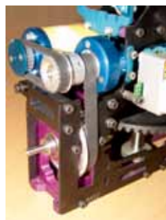
Die beiden Zahnriemengetriebe des Startermotors und der Primärstufe. In der Kupplungsglocke (blau) sitzt die Fliehkraftkupplung, die den Hauptrotor beim Startvorgang sauber auskuppelt
